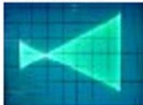
Quand la modulation est mauvaise qualité, l'enveloppe du signal modulé n'est pas identique au signal modulant. Cela est dû au fait que le décalage en tension  $U_o$  est inférieur à l'amplitude  $S_m$  du signal modulant,  $m = \frac{S_m}{U_o} > 1$  soit  $U_o < S_m$  on dit qu'il y'a surmodulation.
