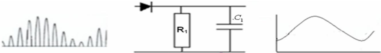
**Remarque:** Pour obtenir une bonne détection d'enveloppe il faut que la constante de temps du dipôle  $R_1 C_1$  vérifie la condition suivante:
