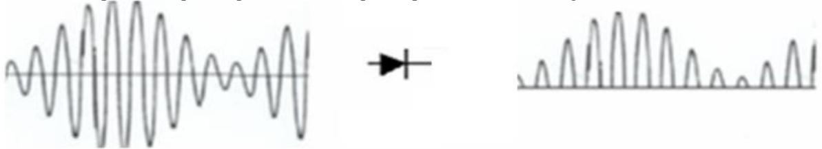
En associant la diode et le filtre passe-bas (qui élimine la partie restante de la porteuse) on obtient le détecteur d'enveloppe.
