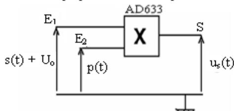
On applique à l'entrée  $E_1$  du multiplieur le signal modulant  $s(t)$  après lui avoir ajouter une tension continue  $U_0$  (dont nous allons voir l'utilité par la suite) puis on applique à l'entrée  $E_2$  la tension porteuse  $p(t)$  et on obtient à la sortie S du multiplieur la tension modulée  $u_s(t)$ .
