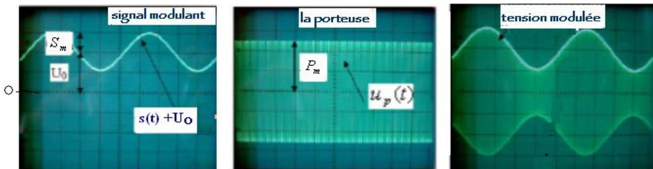
La tension modulée  $u_s(t)$  obtenue à la sortie du multiplieur est proportionnelle au produit des deux tensions :  $p(t)$  et  $(s(t)+U_0)$ .
